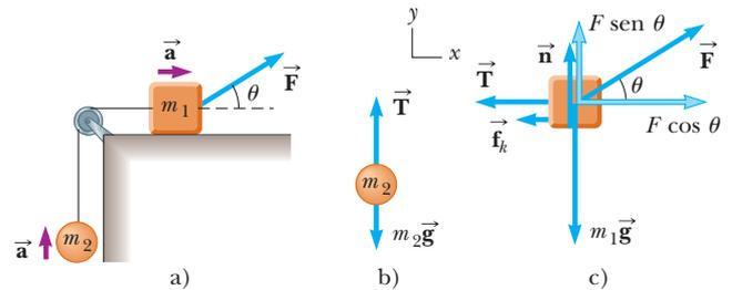
**Figura 5.20** (Ejemplo 5.13) a) La fuerza externa  $\vec{F}$  aplicada como se muestra puede hacer que el bloque acelere hacia la derecha. b) y c) Diagramas de cuerpo libre que suponen que el bloque acelera hacia la derecha y la bola acelera hacia arriba. La magnitud de la fuerza de fricción cinética en este caso está dada por  $f_k = \mu_k n = \mu_k (m_1 g - F \sin \theta)$ .
