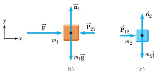
**Figura 5.12** (Ejemplo 5.7). a) Se aplica una fuerza se a un bloque de masa  $m_1$ , que empuja a un segundo bloque de masa  $m_2$ . b) Diagrama de cuerpo libre para  $m_1$ . c) Diagrama de cuerpo libre para  $m_2$ .
