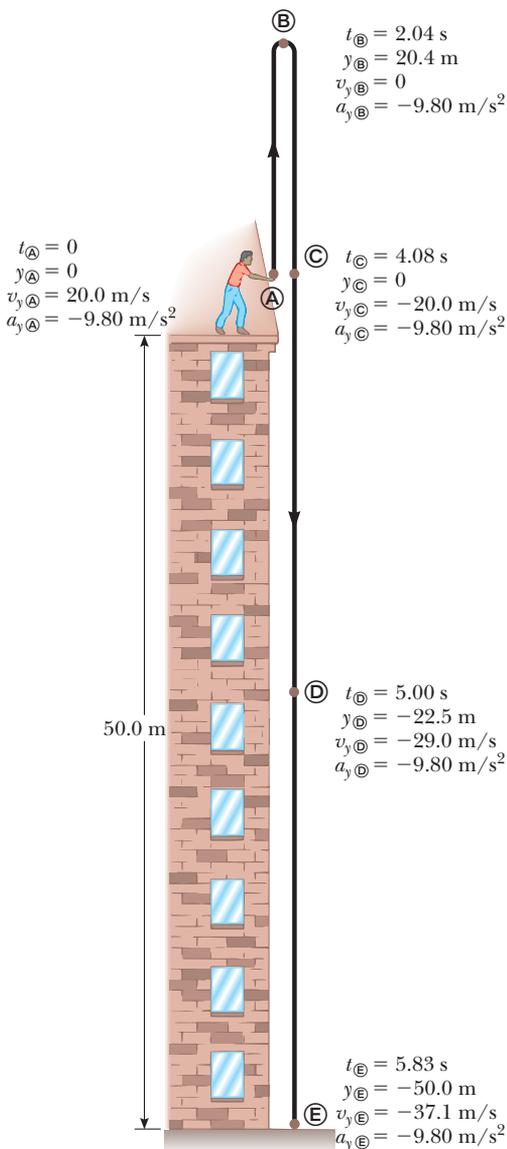
**Figura 2.14** (Ejemplo 2.10) Posición y velocidad frente a tiempo para una piedra en caída libre que se lanza inicialmente hacia arriba con una velocidad  $v_{yi} = 20.0 \text{ m/s}$ . Muchas de las cantidades en las etiquetas para los puntos en el movimiento de la piedra se calculan en el ejemplo. ¿Puede verificar los valores que no están calculados?
