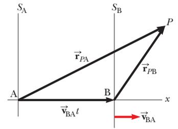
**Figura 4.20** Una partícula ubicada en P es descrita por dos observadores, uno en el marco de referencia fija  $S_A$  y el otro en el marco  $S_B$ , que se mueve hacia la derecha con una velocidad constante  $\vec{v}_{BA}$ . El vector  $\vec{r}_{PA}$  es el vector de posición de la partícula en relación con  $S_A$  y  $\vec{r}_{PB}$  es su vector de posición en relación con  $S_B$ .
