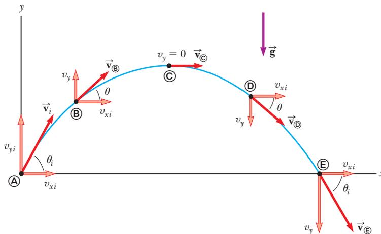
**Figura 4.7** Trayectoria parabólica de un proyectil que sale del origen con velocidad  $\vec{v}_i$ . El vector velocidad  $\vec{v}$  cambia con el tiempo tanto en magnitud como en dirección. Este cambio es el resultado de la aceleración en la dirección  $y$  y negativa. La componente  $x$  de velocidad permanece constante en el tiempo porque no hay aceleración a lo largo de la dirección horizontal. La componente  $y$  de velocidad es cero en el pico de la trayectoria.
