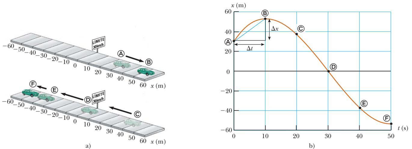
**Figura 2.1** Un automóvil va hacia adelante y en reversa a lo largo de una línea recta. Ya que se tiene interés sólo en el movimiento traslacional del automóvil, se le representa como una partícula. Aquí se han usado tres exhibiciones para la información del movimiento del automóvil. La tabla 2.1 es una exposición tabular de la información. a) Representación pictórica del movimiento del automóvil. b) Representación gráfica (gráfica posición-tiempo) del movimiento del automóvil.
