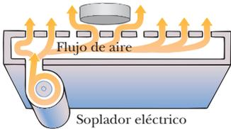
**Figura 5.3** En una mesa de hockey de aire, el aire que sopla a través de los hoyos en la superficie permite que el disco se mueva casi sin fricción. Si la mesa no acelera, un disco colocado sobre la mesa permanecerá en reposo.
