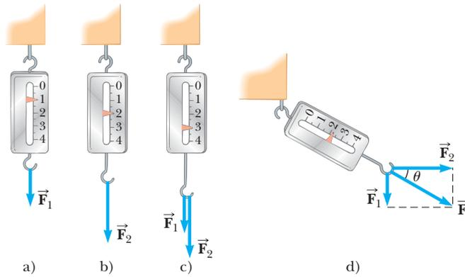
**Figura 5.2** La naturaleza vectorial de una fuerza se prueba con una balanza de resorte. a) Una fuerza descendente  $\vec{F}_1$  estira el resorte 1.00 cm. b) Una fuerza descendente  $\vec{F}_2$  estira el resorte 2.00 cm. c) Cuando  $\vec{F}_1$  y  $\vec{F}_2$  son simultáneas, el resorte se estira 3.00 cm. d) Cuando  $\vec{F}_1$  es descendente y  $\vec{F}_2$  es horizontal, la combinación de las dos fuerzas estira el resorte 2.24 cm.
