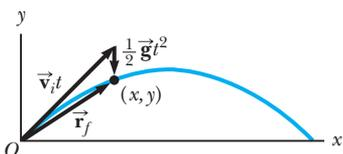
**Figura 4.8** Vector de posición  $\vec{r}_f$  de un proyectil lanzado desde el origen, cuya velocidad inicial en el origen es  $\vec{v}_i$ . El vector  $\vec{v}_i t$  sería el desplazamiento del proyectil si no hubiera gravedad, y el vector  $\frac{1}{2} \vec{g} t^2$  es su desplazamiento vertical de una trayectoria recta debido a su aceleración gravitacional descendente.
