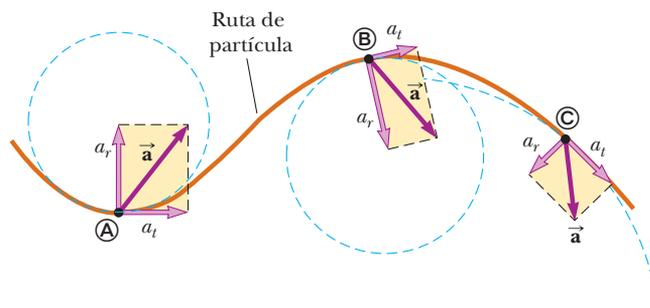
**Figura 4.16** El movimiento de una partícula a lo largo de una trayectoria curva arbitraria que se encuentra en el plano  $xy$ . Si el vector velocidad  $\vec{v}$  (siempre tangente a la trayectoria) cambia en dirección y magnitud, las componentes de la aceleración  $\vec{a}$  son una componente tangencial  $a_t$  y otra componente radial  $a_r$ .
