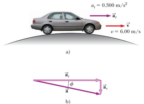
**Figura 4.17** (Ejemplo 4.7) a) Un automóvil pasa sobre una elevación que tiene forma de círculo. b) El vector aceleración total  $\vec{a}$  es la suma de los vectores aceleración tangencial y radial  $\vec{a}_t$  y  $\vec{a}_r$ .
