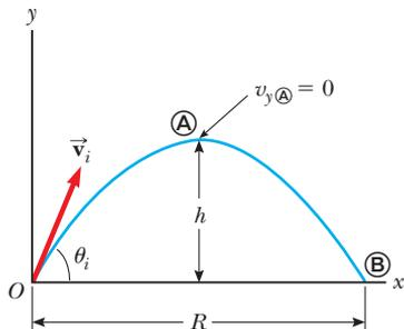
**Figura 4.9** Proyectil lanzado sobre una superficie plana desde el origen en  $t_i = 0$  con una velocidad inicial  $\vec{v}_i$ . La altura máxima del proyectil es  $h$  y el alcance horizontal es  $R$ . En  $\textcircled{A}$ , el máximo de la trayectoria, la partícula tiene coordenadas  $(R/2, h)$ .
