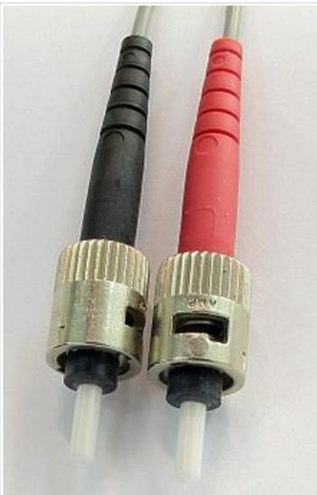
Conectores de [cable](#) de fibra óptica tipo ST.
