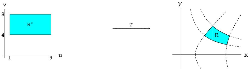
Aplicando la transformación  $u = x^2 - y^2$ ,  $v = 2xy$ , la región  $R$  del plano  $XY$  de la derecha de la figura se transforma en la región  $R'$  del plano  $UV$  representada en la izquierda de la figura. Vamos a comprobar que dicha transformación es regular.
